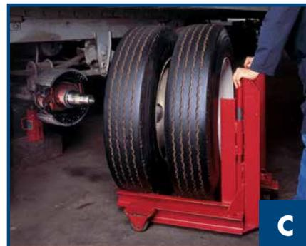
**第五步：** 按270N.m的紧固力矩紧固轴头螺母，在紧固螺母的同时转动几圈轮毂/车轮。然后回退螺母一整圈（见图D）。按照制造商建议和TMC要求安装车轴紧固件，以确保正确的安装和游隙调整。
