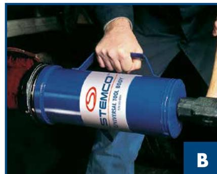
**第三步：** 预润滑内轴承内圈，并将轴承内圈放到轴头上。
