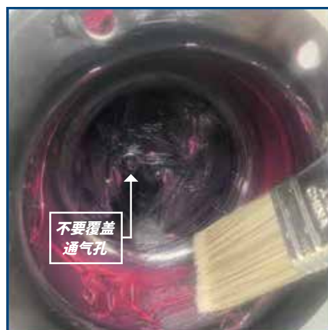
图 4: 填充冲压钢轮毂盖内部
